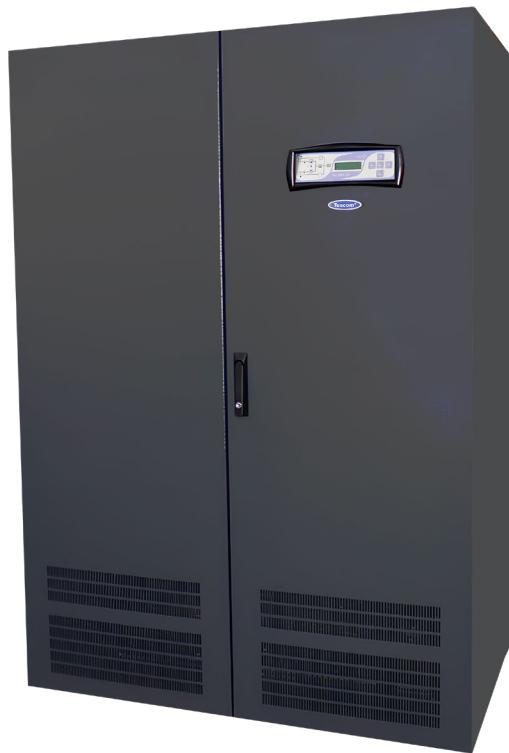
STS 4000 3 fazlı, 4 kutuplu statik transfer anahtarı, kritik yükleri iki bağımsız AC güç hattından herhangi birine kesintisiz şekilde transfer eder. Sistem iki AC girişi izler. Bunlardan herhangi biri belirlenen tolerans dışına çıkar ise kritik yükü diğerine aktarır. STS 4000 ile kullanılan sistemlerin enerji kalitesi arttırlarak parazitlerden ve kısa kesintilerden etkilenme ihtimali azaltırken yedek güç sistemi kazanılmış olur.
